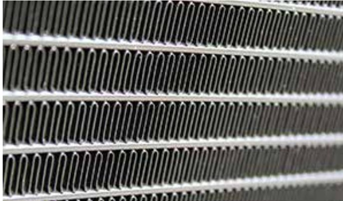
**CONDENSATORI** ad aria con batteria microcanale, in lega di alluminio ad alta resistenza (LLA- Long Life Alloy). L'elevata resa viene garantita con un 30% in meno di refrigerante rispetto al condensatore in rame-alluminio. Il minor peso totale rappresenta un vantaggio per trasporto, installazione e manutenzione. Opportunità di trattamento e-coating per siti con contaminazione gravosa.
