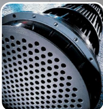
**EVAPORATORE** a piastre o a fascio tubiero ad espansione secca in base alla taglia della macchina. L'evaporatore a piastre è realizzato in acciaio AISI 316 e brasatura in rame, con adeguato isolamento anticondensa e protezioni contro disfunzioni e ghiacciamento. L'evaporatore a fascio ad espansione secca è interamente sviluppato in-house e caratterizzato da tubi in rame rigati per una facile ispezione e pulizia.
